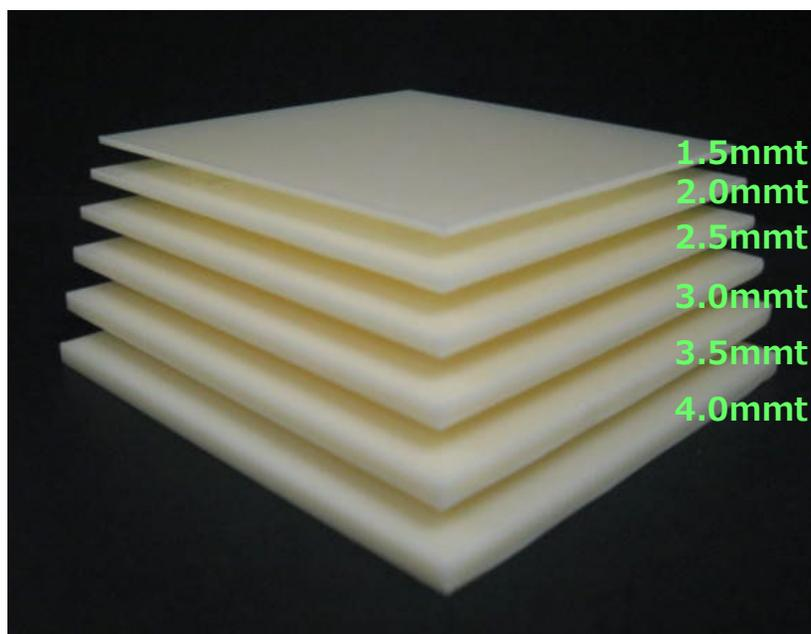
面衝撃試験、劣化促進試験など多用途の試験片としてご利用いただけます。
